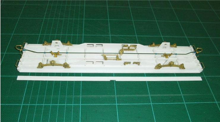
Vorerst werden die Bremskabeln nachgebildet mit Drahtstücken (0.8 mm) die die Bremshebel mit dem Bremszylinder verbinden. Weiter werden die Bremsklotzen mit den Brems-Dreiecken verbunden und in ihre Führungen gesetzt.
