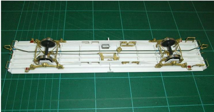
Das Fahrwerk wird in Oxyd braun grundiert.
