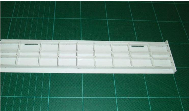
Der Haupt-Langs träger (mit Aussparungen für die Querträger) wird gedoppelt mit einer Flachstreife die entlang nebenan geklebt wird.
