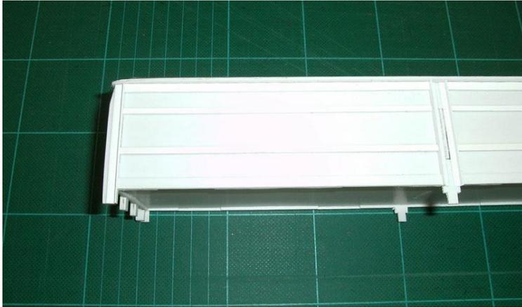
Am Oberseite werden die Längsprofilen (Streife 1.5x 3mm) geklebt.
