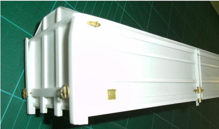
Aus den Winkelprofilen in die Seitenmitte werden kleine Aussparungen geschnitten für die Quergriffe von der Türverriegelung.
