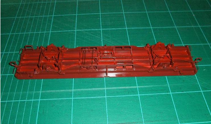
Bei dem Zusammenbau des Gehäuses werden die beide Stirnseiten und die Querspante in die Aussparungen auf die Seitenwände geklebt.
